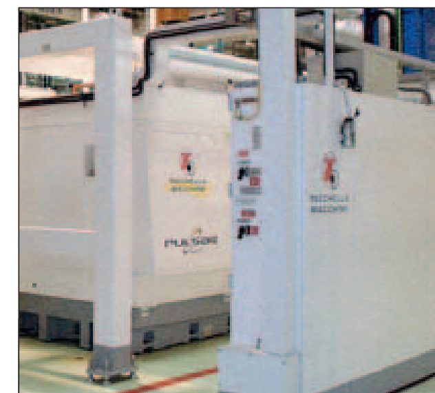
Pulsar è una rettificatrice convenzionale dotata di speciali conformazioni a pacco degli utensili impiegati con mole di diametro 760 mm. Nel caso di Opel Austria Powertrain, la macchina può realizzare tutti i diametri esterni in tolleranze di pochi micron
