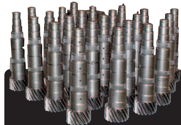
Le rettificatrici Tacchella impiegate presso Opel Austria Powertrain sono state costruite per la rettifica da esterni in tondo dei nuovi alberi cambio a sei marce, da installare sulle marche di veicoli del gruppo GM Europa e FIAT Auto
